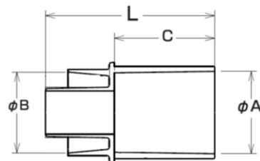
■材質 PVC 断熱材:発泡PE
